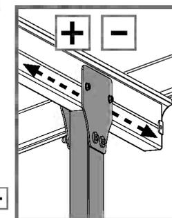
**Note:** le montage du mur et le réglage de la distance du toit déterminent l'angle du toit et la profondeur totale (distance de la gouttière du mur). Si le mur est monté plus en hauteur et si la distance entre le mur et les piliers est diminuée, l'angle du toit augmente et la profondeur totale est diminuée. Serrez toutes les vis après avoir achever l'assemblage.
