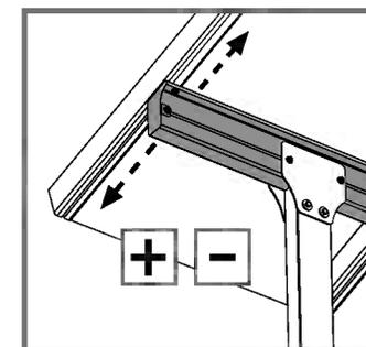
**3.** La distance des piliers aux extrémités des côtés peut être réglée entre 0 et 54 cm
